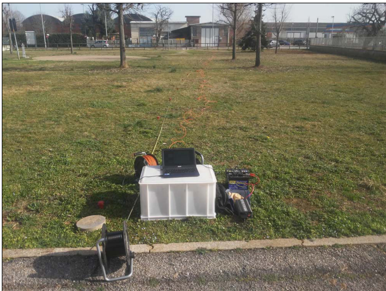
Figura 3: immagine fotografica dello stendimento sismico eseguito in sito.
