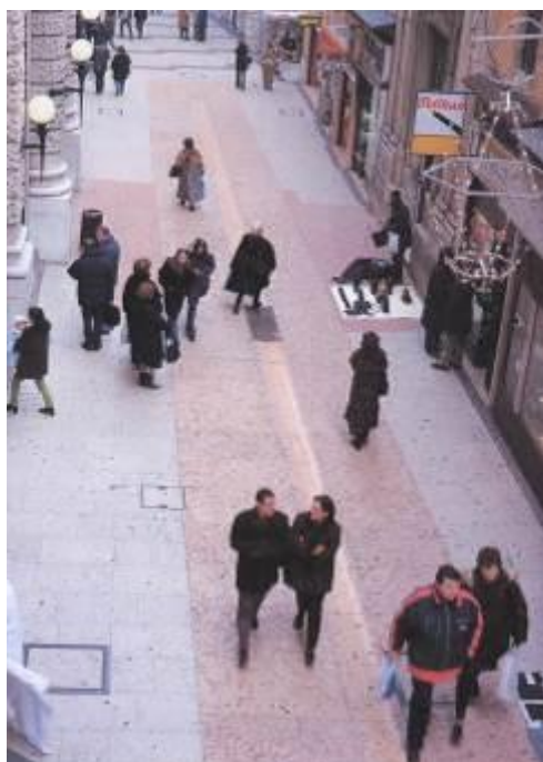
1.2 b) Pavimentazione in lastre di pietra di Lessinia Via Nuova, Verona
